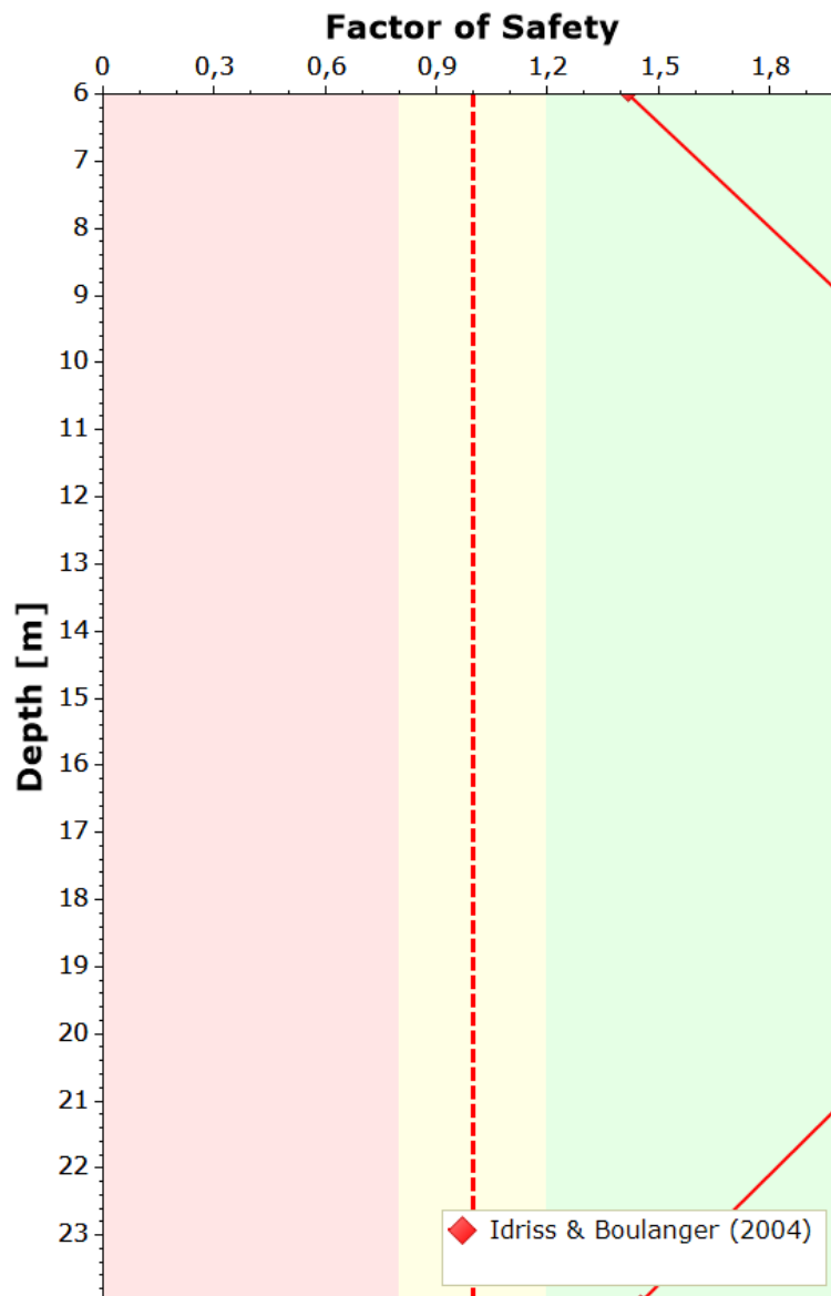
Figura 32: Fattore di sicurezza calcolato con il metodo di Idriss e Boulanger
